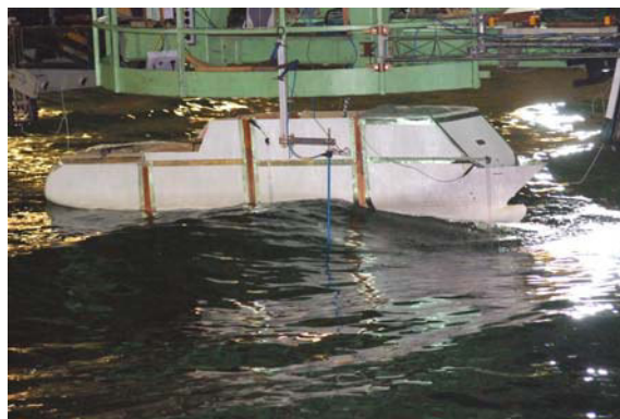
Ensayos de comportamiento en olas
